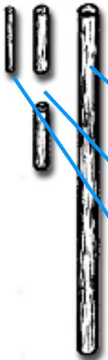
Haltestab: \_\_\_\_\_ : 8 mm  $\phi$ , 145 mm Länge
